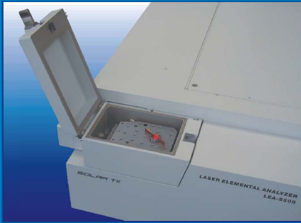
Проба на столике для образцов
